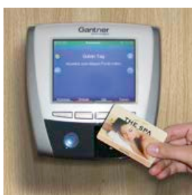
Système de verrouillage en ligne avec terminal d'information central, avec PIN ou transpondeur/support de données
