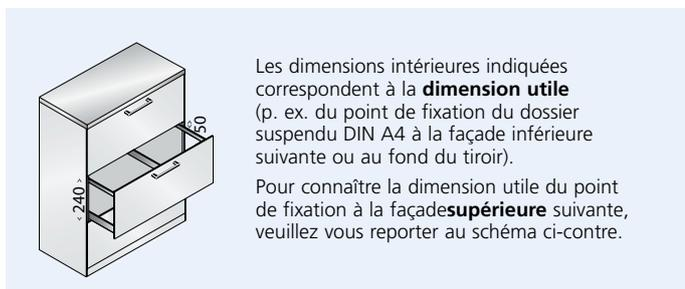
Les dimensions intérieures indiquées correspondent à la **dimension utile** (p. ex. du point de fixation du dossier suspendu DIN A4 à la façade inférieure suivante ou au fond du tiroir).
